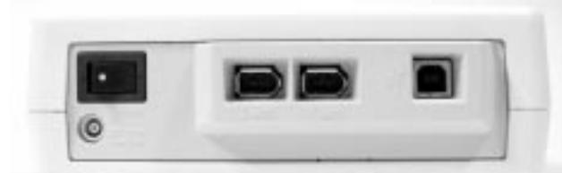
На противоположной стороне аппарата кнопка включения, гнездо адаптера питания, два интерфейсных гнезда IEEE-1394 (второе – для последовательного подключения устройств) и одно – USB.
