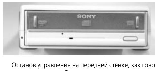
Органов управления на передней стенке, как говорится, кот наплакал. Справа налево: кнопка извлечения диска, прямоугольный индикатор состояния привода, аварийно-спасательная дырка («отмычки» в комплекте нет) и индикатор сетевого питания.
