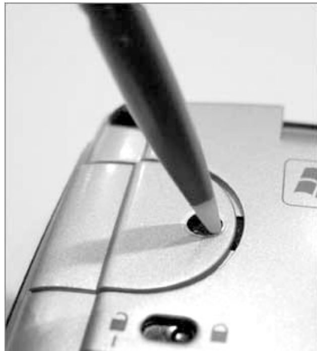
На задней панели — отсек резервной батарейки и съемный аккумулятор. Чтобы заменить батарейку, нужно вдавить пером кнопку и снять крышку.
