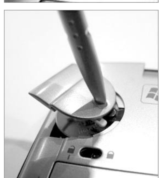
Для замены аккумулятора достаточно сдвинуть пером защелку влево и потянуть аккумулятор вниз.
